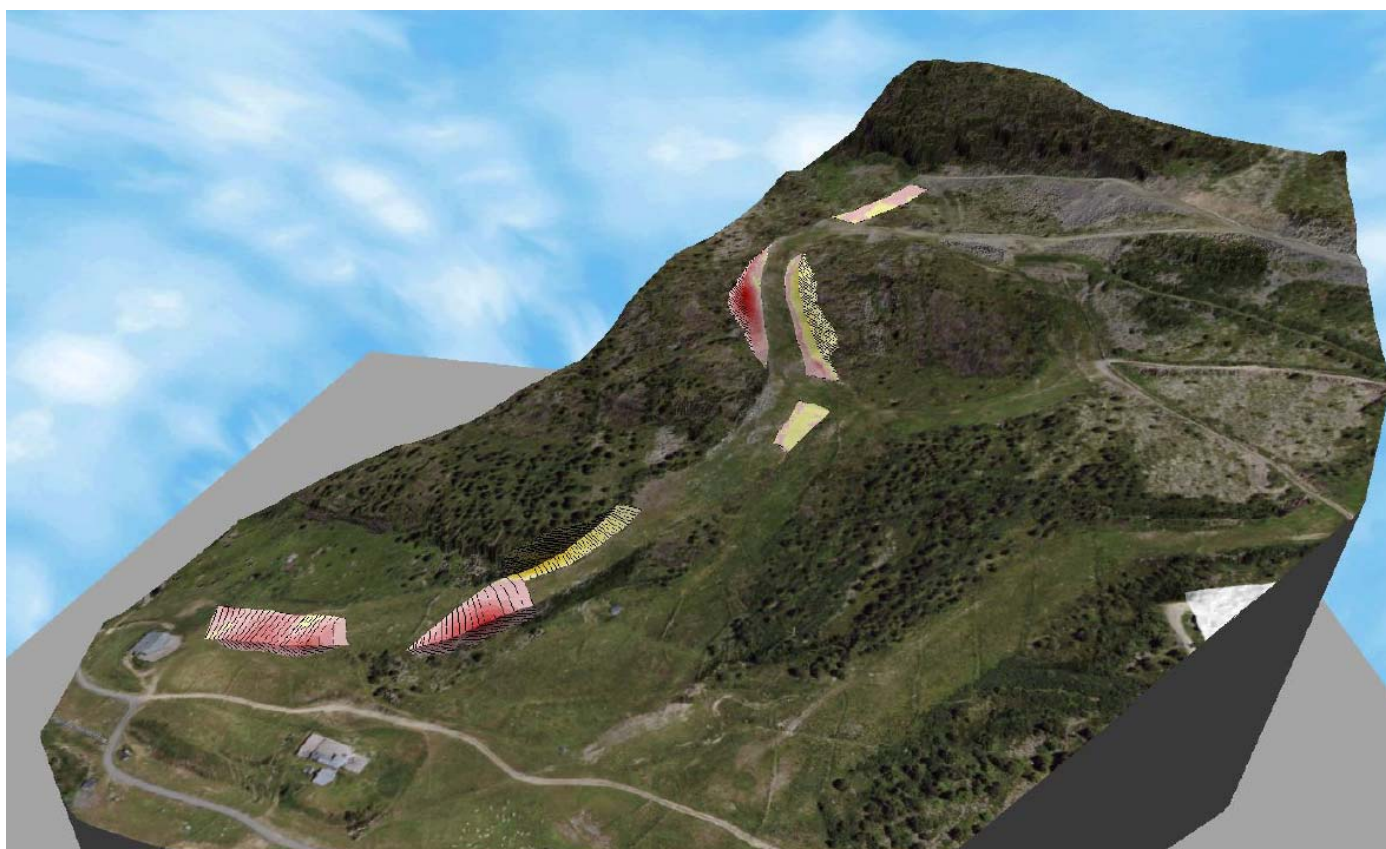
Modèle 3D des zones de terrassement (source MND)
