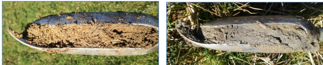
Illustration 3 : Traces d'oxydation et réductisol
