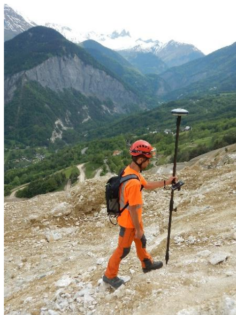
Levé d'un profil au GPS GNSS RTK
