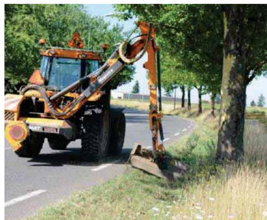
Fauchage mécanisé d'une noue
