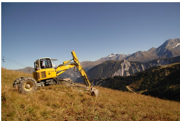
UTILISATION D'UNE PELLE ARAIGNEE POUR LA CREATION D'UNE TRANCHEE
