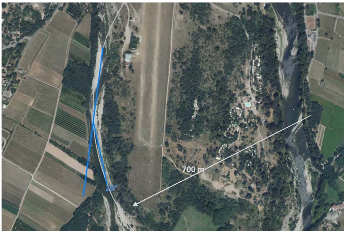
Figure 9 - évaluation du rayon de courbure du méandre et du changement de direction
