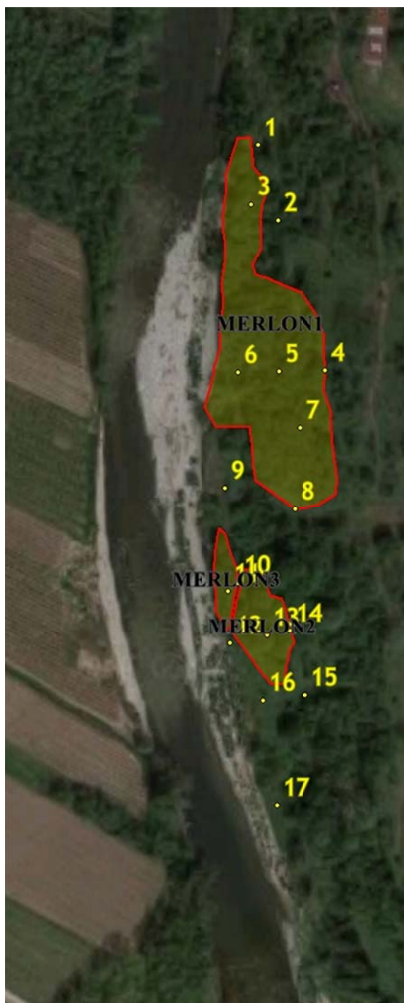
Figure 37 - Positionnement des merlons et des sondages, échelle 1/2000 (le sondage n°11 n'a pu être réalisé pour une question d'accès)
