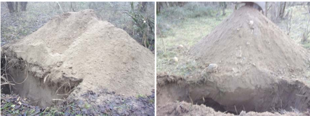
Figure 39 - A gauche : sondage 7, réalisé en sommet de merlon, entièrement constitué de sables. A droite : sondage 8, réalisé entre les merlons 1 et 2. Le toit des graviers se trouve à 1.80 m de profondeur sous un horizon superficiel limoneux, puis un horizon de sables
