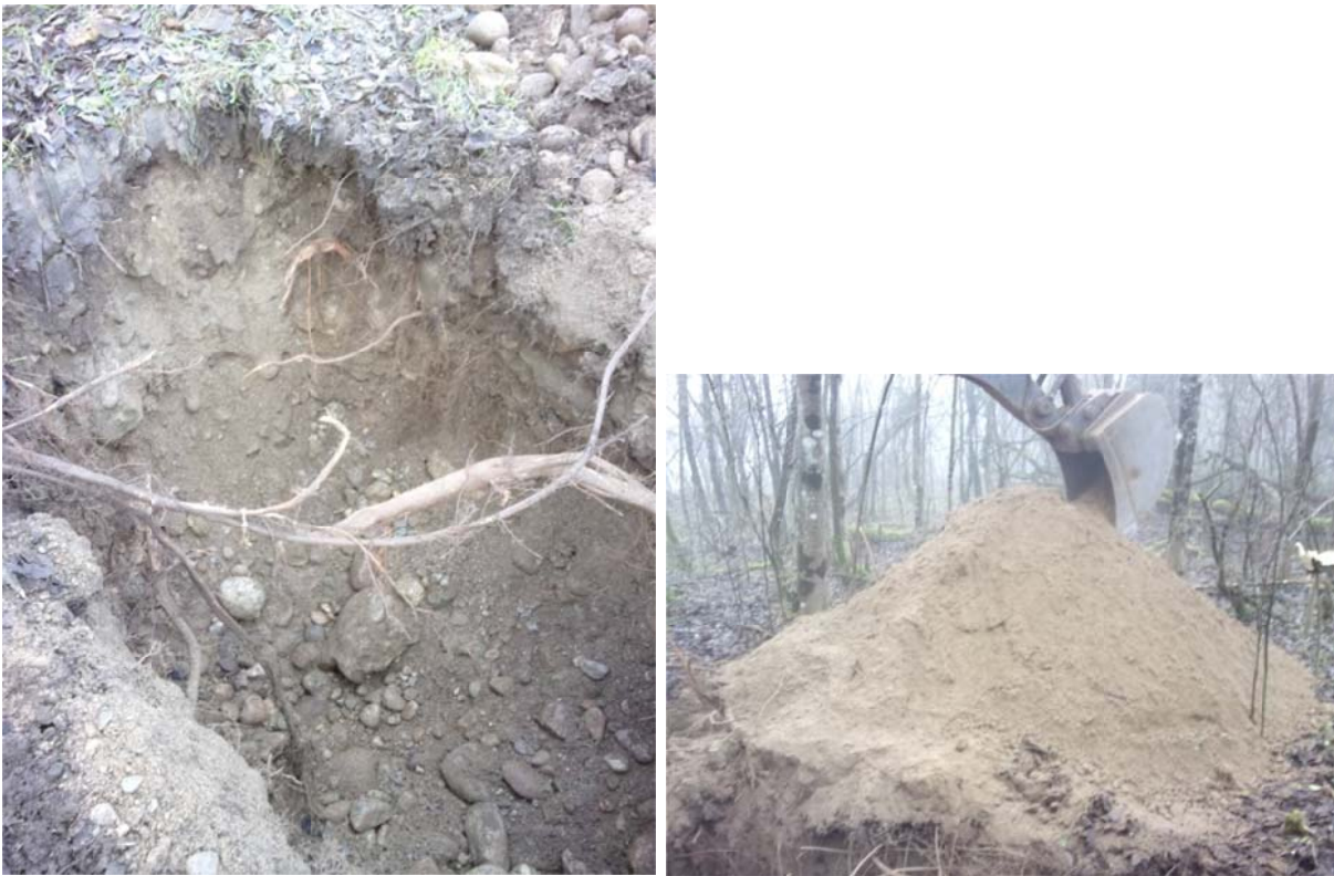
Figure 38 - A gauche : sondage 4, réalisé en pied de merlon. On y trouve des graviers et galets dans une matrice de sables ; à droite : sondage 5, réalisé en sommet de merlon, entièrement constitué de sables
