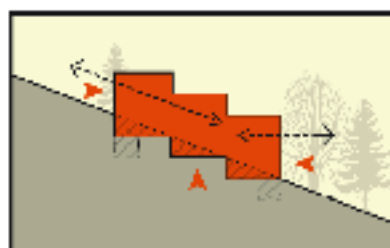
Illustration de la règle : réduire les terrassements en s'adaptant à la pente. Source : habiter en montagne référentielle d'architecture (PNRV, PNRC, CAUE 38 et 73)
