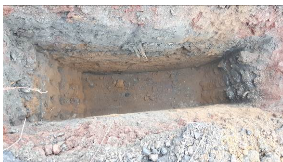
Figure 12 : Vue du profil lithologique du sondage PU5 (avec présence de bois sous l'horizon de remblais)
