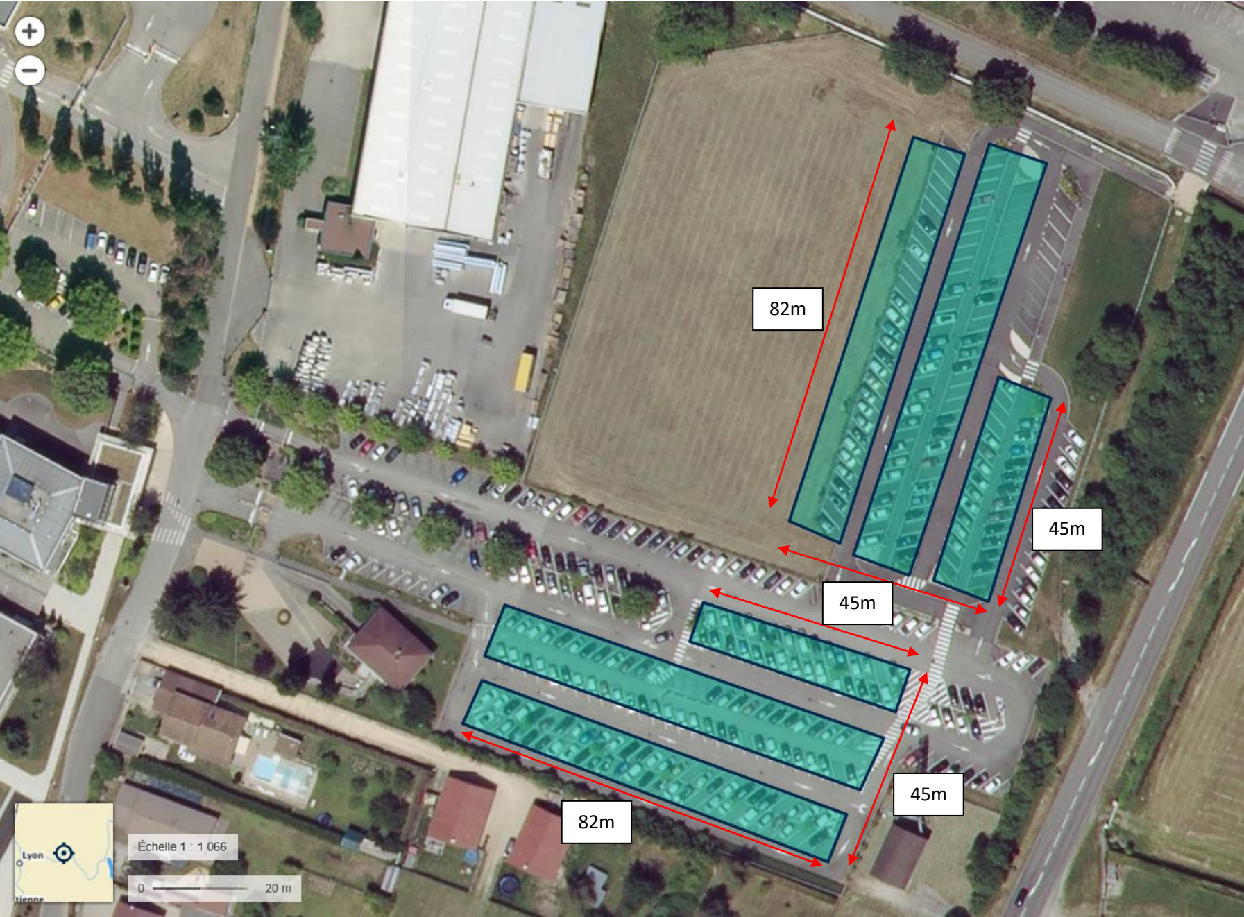
ANNEXE N°4 : Plan de masse, surface couverte totale 5 300 m²
