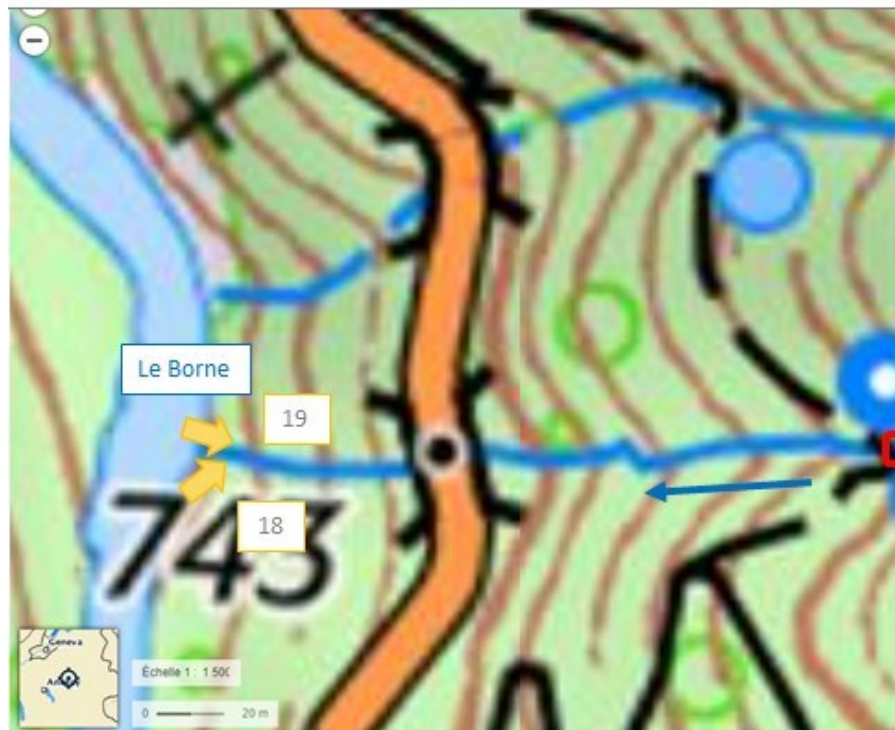
18 Amont immédiat à la confluence avec le Borne – Succession de Cascades comprises entre 2 et 7 mètres infranchissables à la montaison et à la dévalaison avec l'absence de zone de repos ou de fosse de réception
