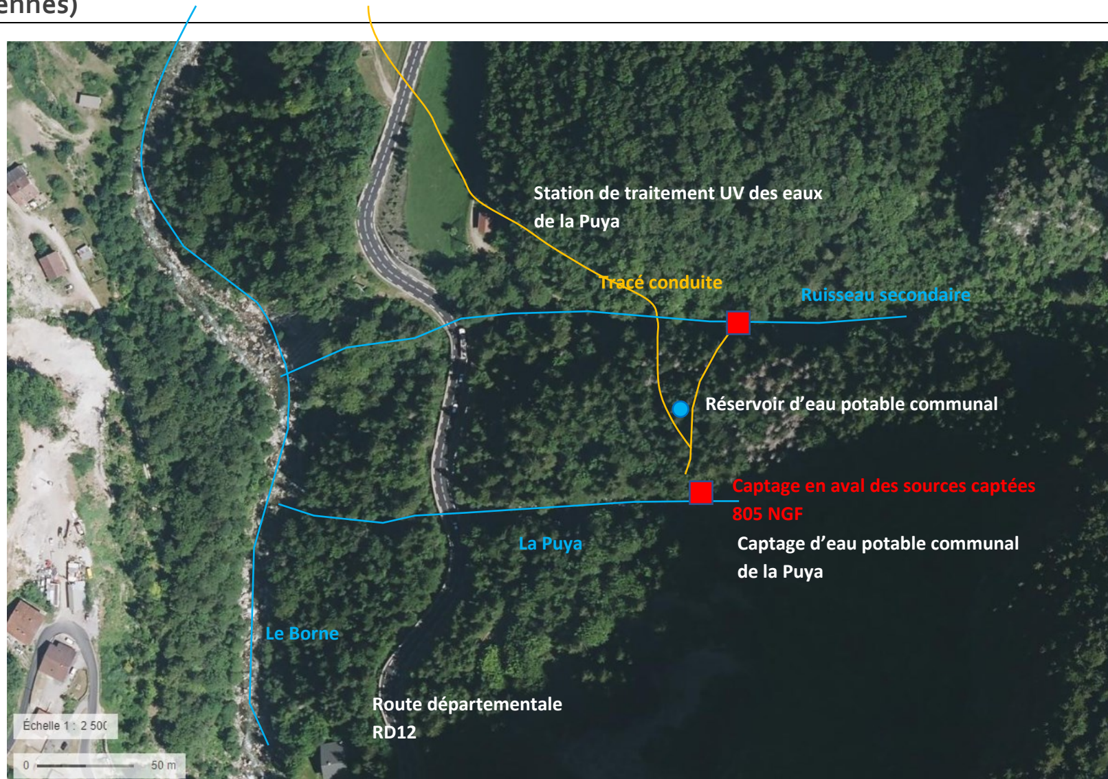
Plan des abords de la prise d'eau sur fond de plan orthophotos – Source Géoportail
