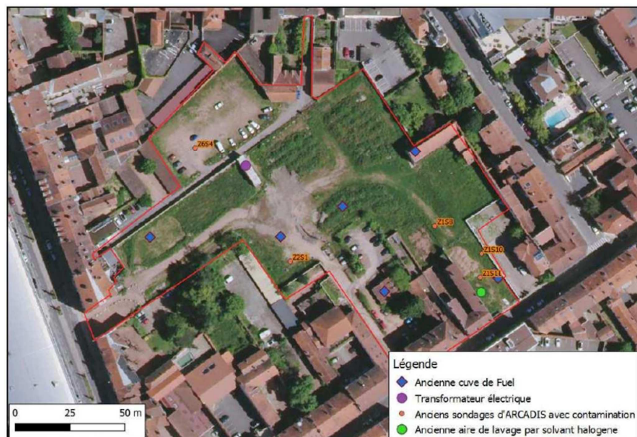
Figure 18 : Plan de repérage des différentes installations susceptibles d'engendrer une pollution des sols (Ville de Roanne / SOCOTEC)
