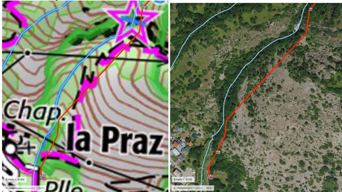
Figure 37 : Tracé de la conduite entre le point K' et le point L à la centrale (source : géoportail.gouv.fr).
