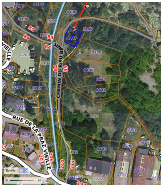
Figure 49 – Cheminement du câble (en jaune) jusqu'au poste identifié (source : geoportail.gouv.fr ).
