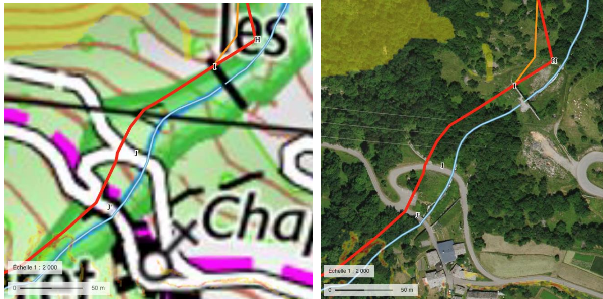
Figure 31 : Tracé de la conduite entre le point I et le point J' (source : géoportail.gouv.fr).
