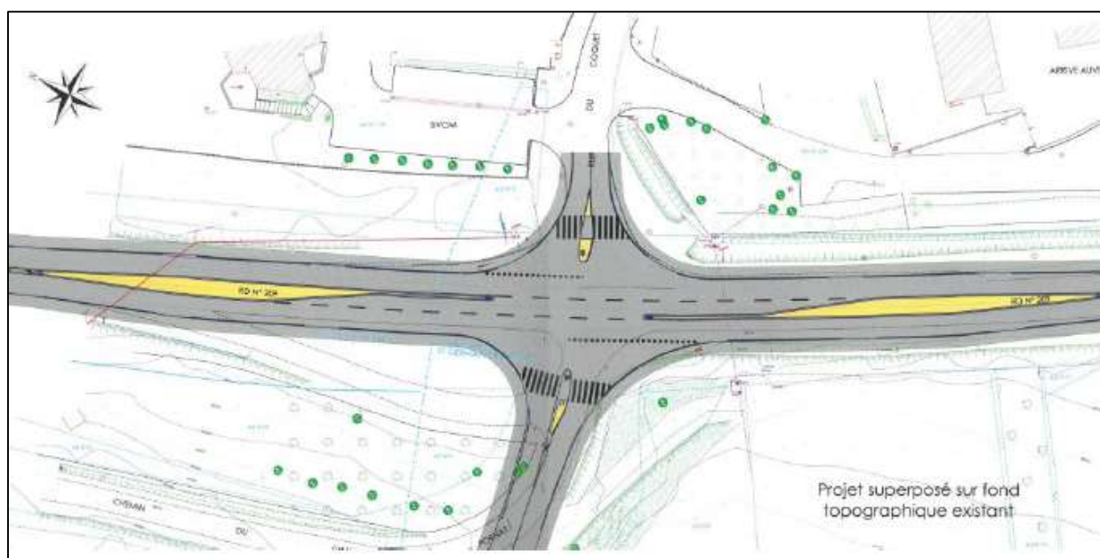
Figure 17. Plan d'aménagement de la variante 2 "tourne à gauche".
