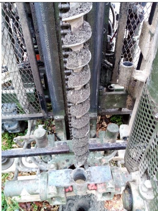
Vue des matériaux au droit du sondage S1
