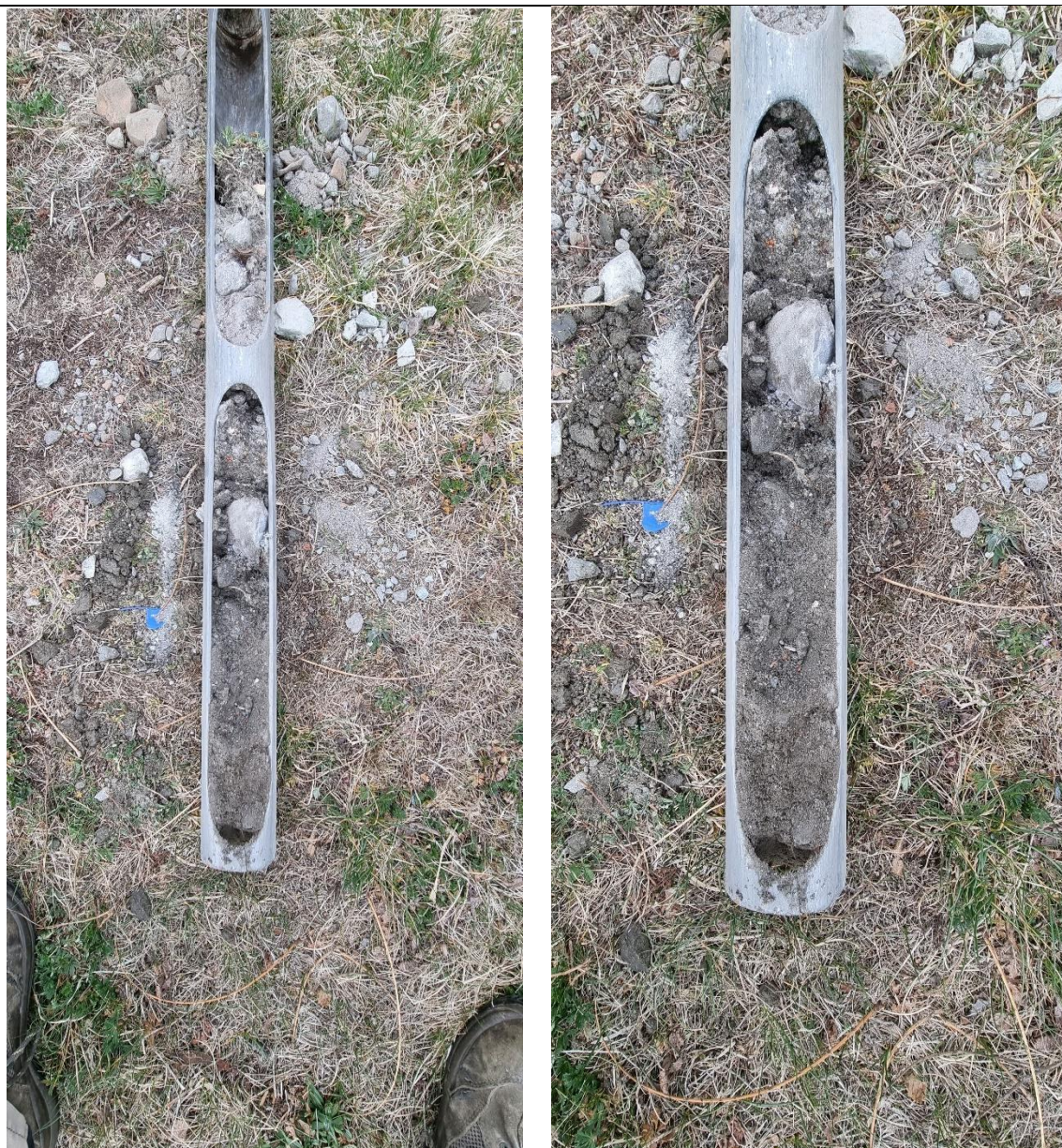
Vue des matériaux au droit du sondage SD7 – Zone Nord du sondage 11
