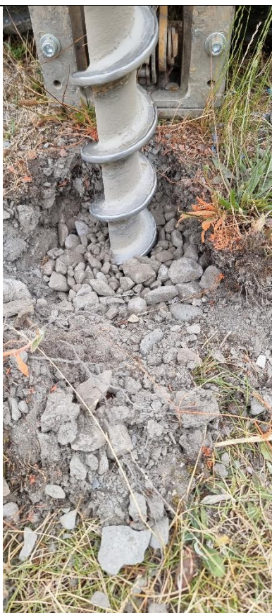
Vue de la cavité rencontrée au droit du sondage SU9 – Emplacement au Nord du sondage SU7
