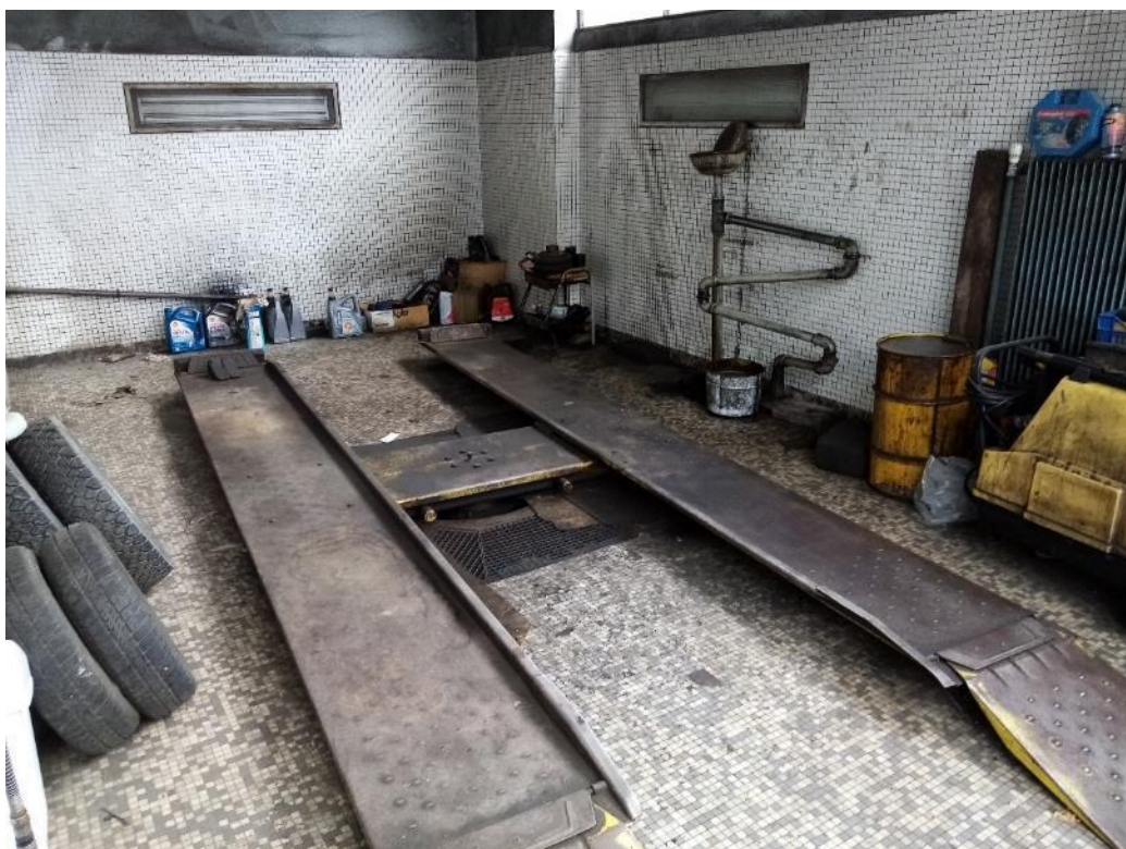
Pont élévateur sur vérin hydraulique enterré
