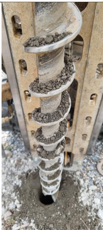
Vue des matériaux au droit du sondage SU2 – Emplacement proche des anciens transformateurs
