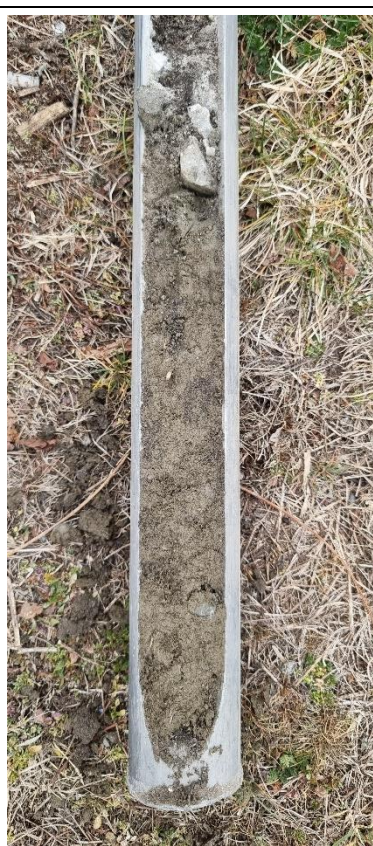
Vue des matériaux zoomés au droit du sondage SD6 – Zone Sud du sondage 11
