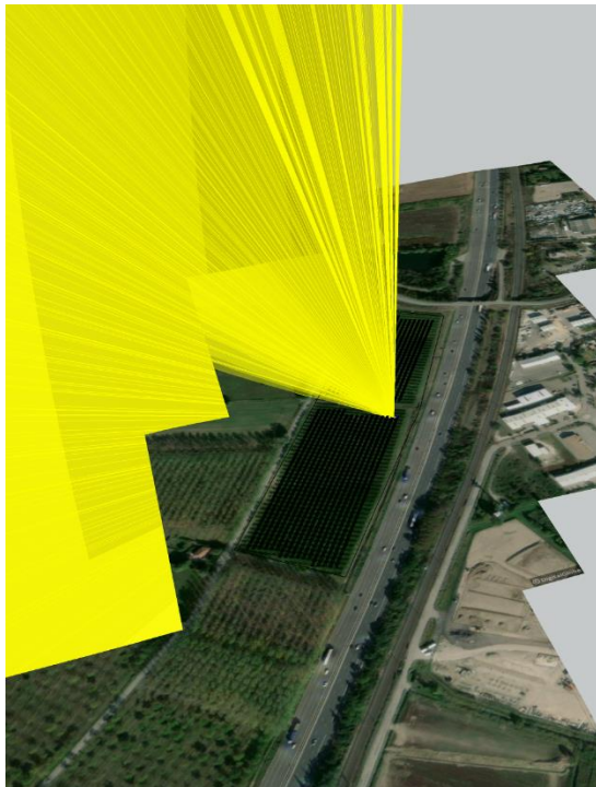
Figure 13: rayons réfléchis (orientation Ouest, inclinaison : 50°)
