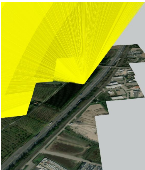
Figure 14: rayons réfléchis (orientation Ouest, inclinaison : 30°)
