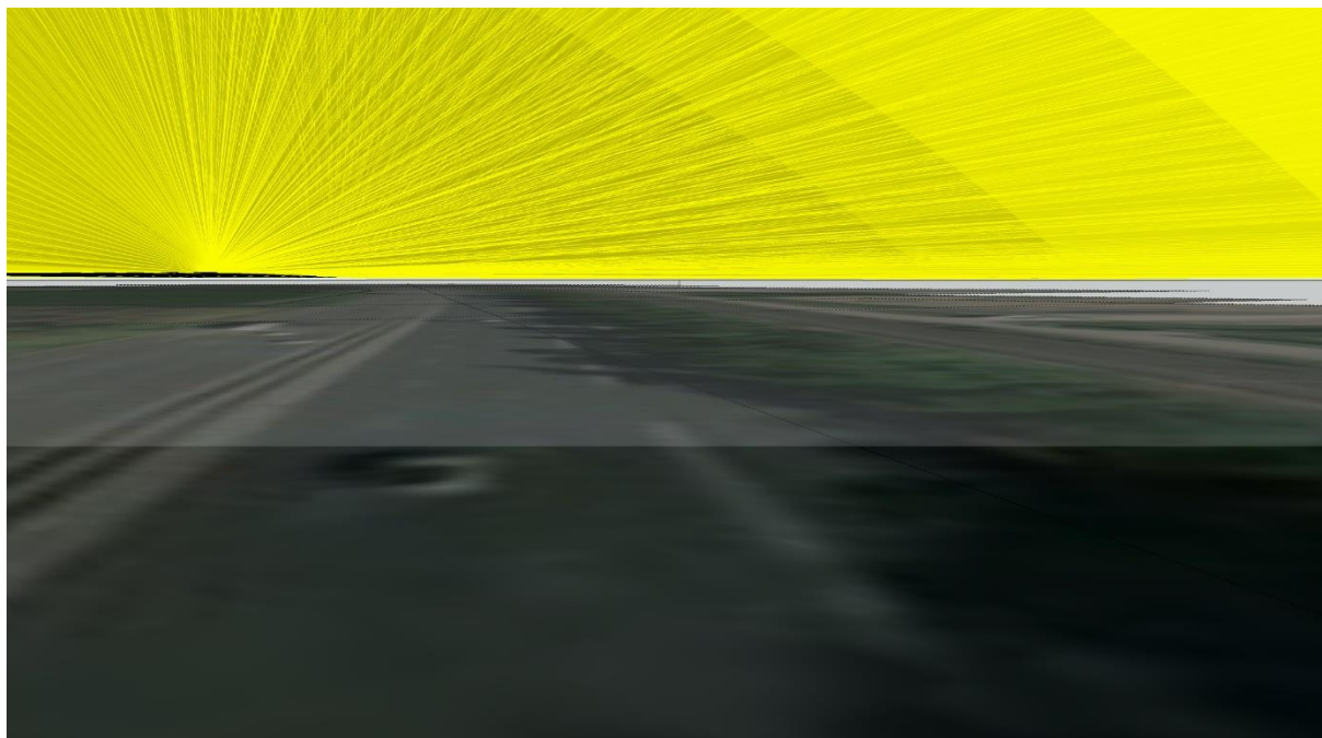
Figure 7: rayons réfléchis (modules à l'horizontale)
