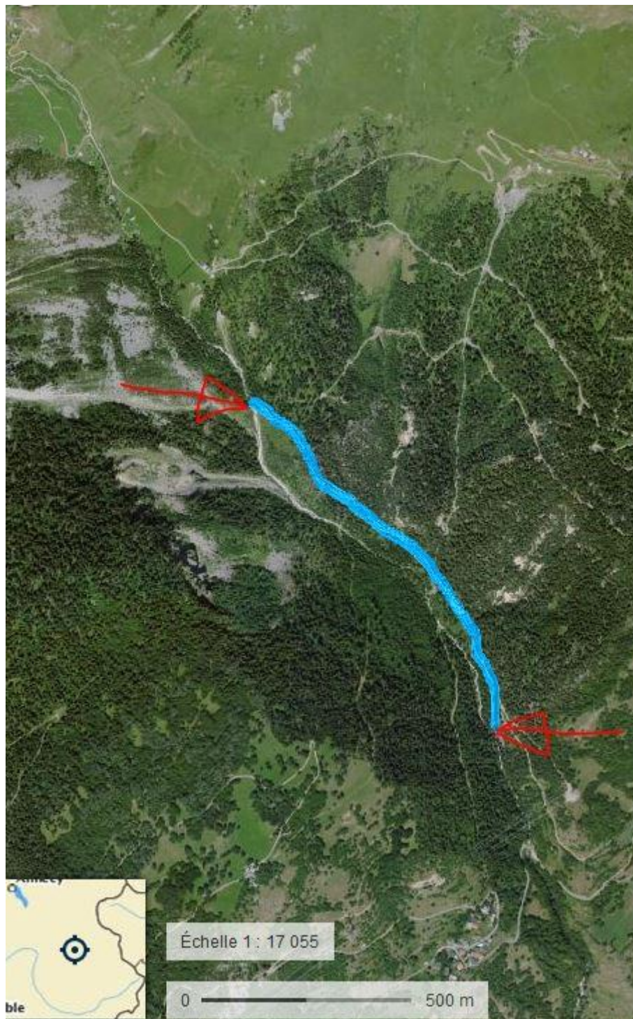
Projet de tracé pour la conduite forcée enterrée
