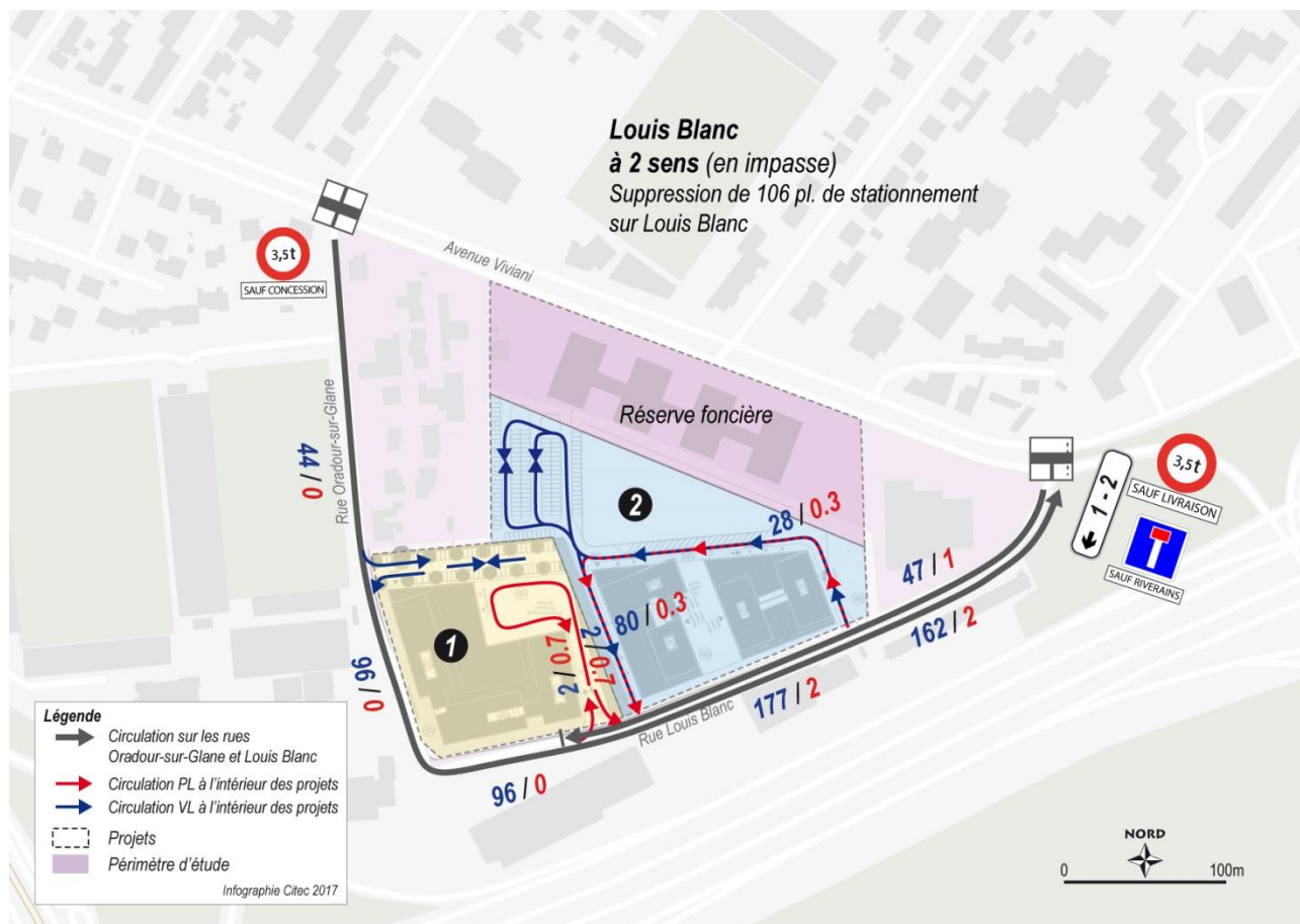
Figure 19 – Schéma de circulation Louis Blanc à 2 sens et charges en HPS générées par le projet Deltalys
