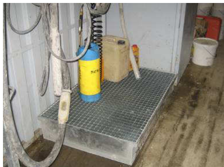
Bac de rétention pour le stockage de produits chimiques
