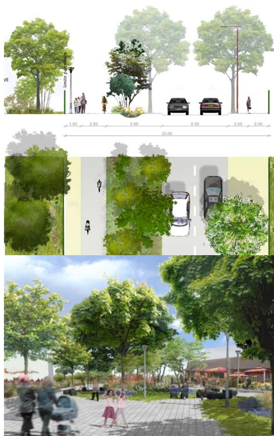
La voirie primaire : coupe en travers et plan de principe
