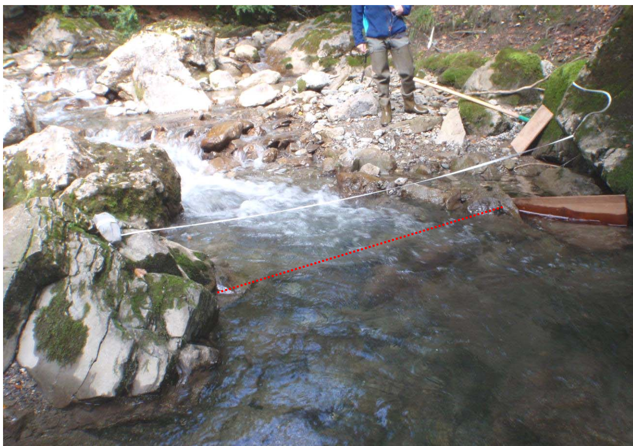
Figure 14 : Section 1 de jaugeage - faibles débits (amont immédiat du pont)
