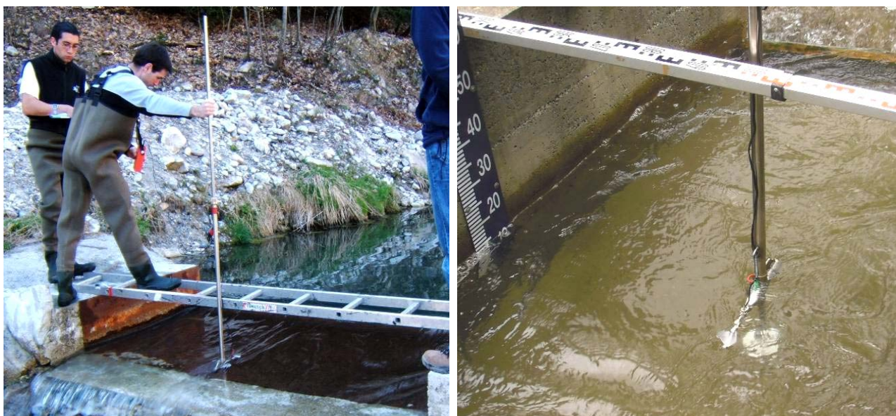
Figure 13 : Mesure de débit au micromoulinet
