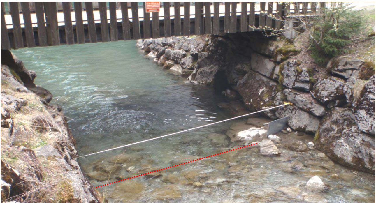
Figure 16 : Section 3 de jaugeage - moyens à forts débits (environ 50 mètres en aval de la station de mesure)
