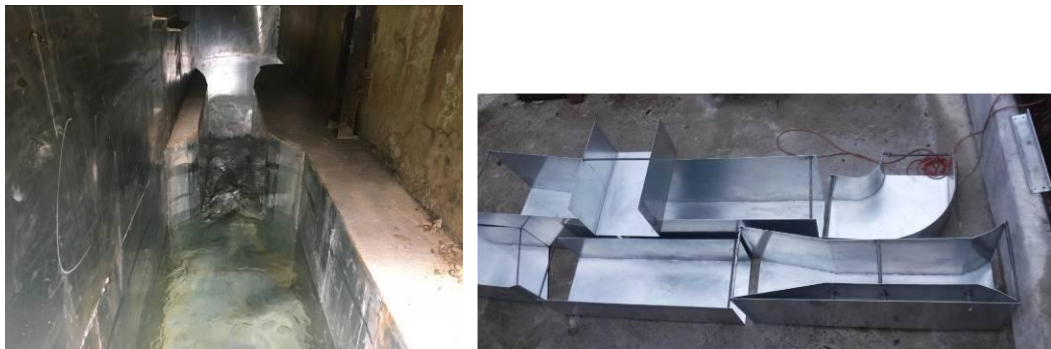
Figure 15 : Exemple de venturi pour contrôle du débit
