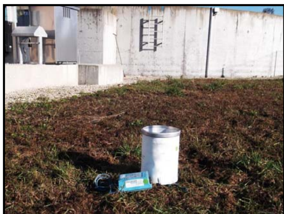
Pluviomètre sur le site de STEP
