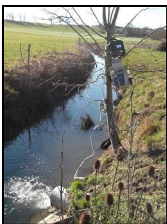
Point de mesure C (Trop-plein amont STEP) – Mainstream
