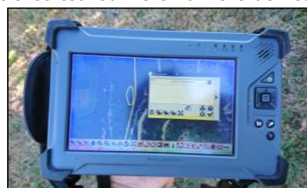
Figure 13 : Tablette numérique équipée d'un GPS et du logiciel CARTOLANDER
