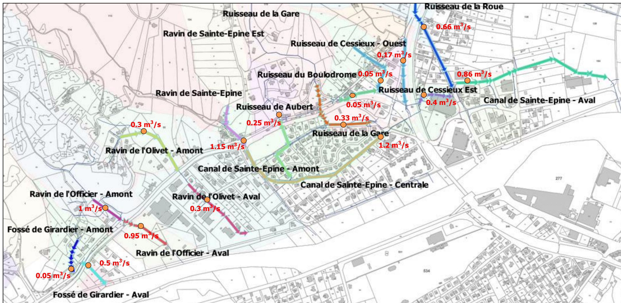
Figure 27 : Capacité maximale des tronçons étudiés de la partie Sud
