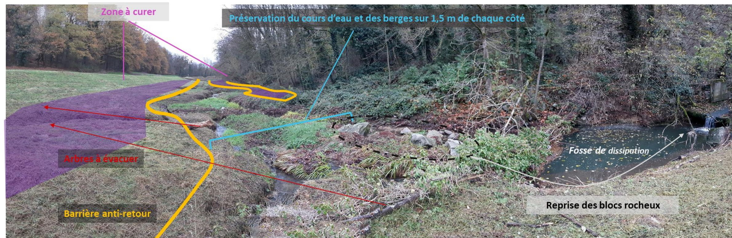
Figure 2 : Vue depuis l'amont du bassin à curer, des travaux et mesures prévues © EODD 2020
