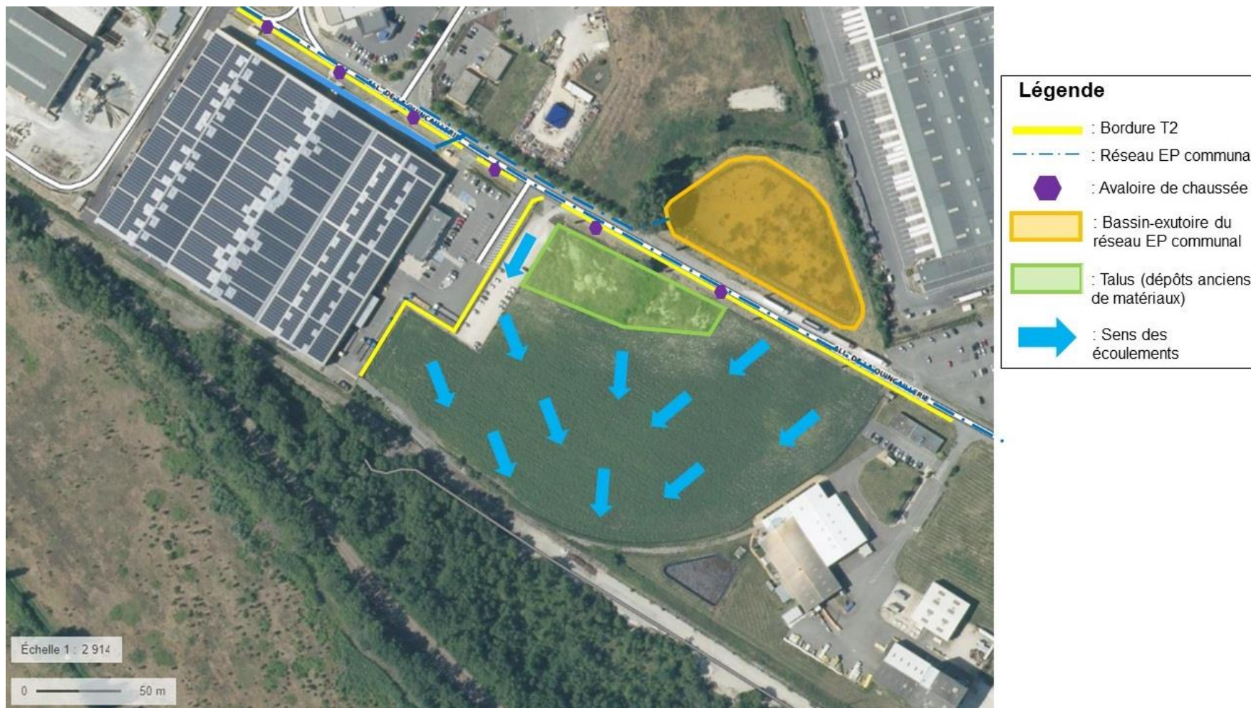
Figure 7 : Schéma des ouvrages hydrauliques existants et des écoulements de surface au sein de la zone d'implantation du projet (Source : GEOPORTAIL)
