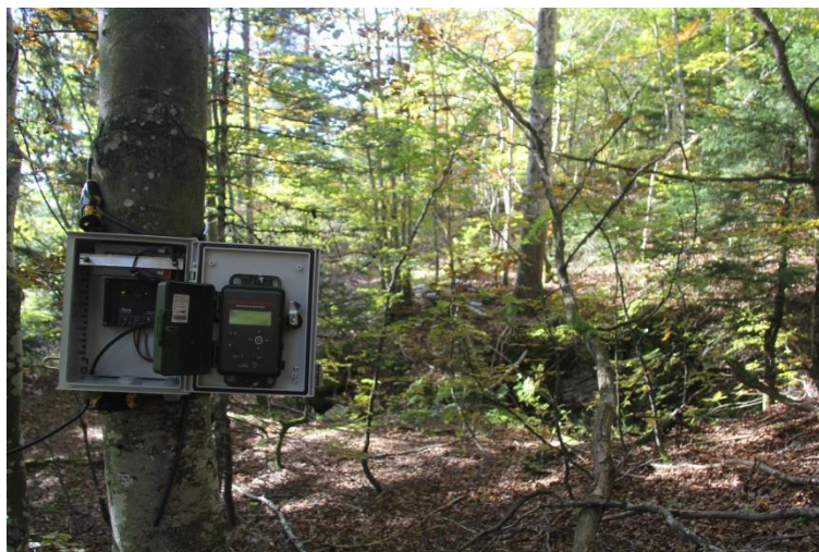
Photographie 9 : Installation de l'enregistreur automatique et du boîtier étanche autonome
