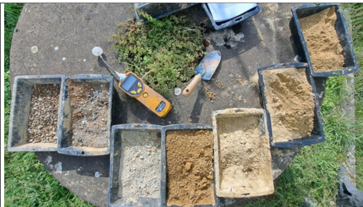
Fig. 9 - Exemple de relevés de cutting (sondage PZ1), de la surface vers le fond, réparti de gauche à droite. Le photoioniseur indique l'horizon de prélèvement, (plus forte concentration de gaz d'hydrocarbures et couleur grise légère).
