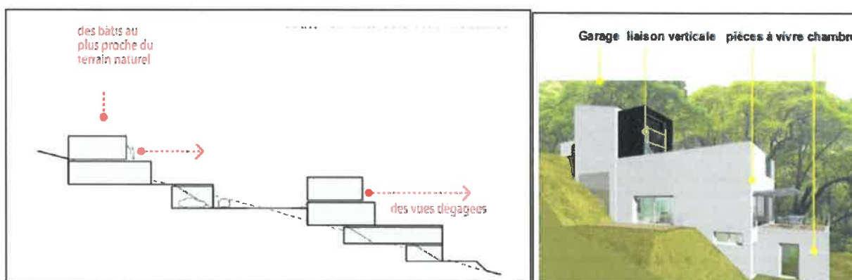
Figure 4 – Principe d'intégration dans la pente et limitation des vues dans le paysage (Source : SEM Velay, OSMOSE Paysage et AB2R)
