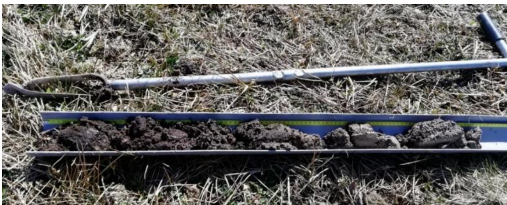
Figure 8 : Exemple de carottage réalisé à la tarière manuelle Edelman (source : EODD, 2022)
