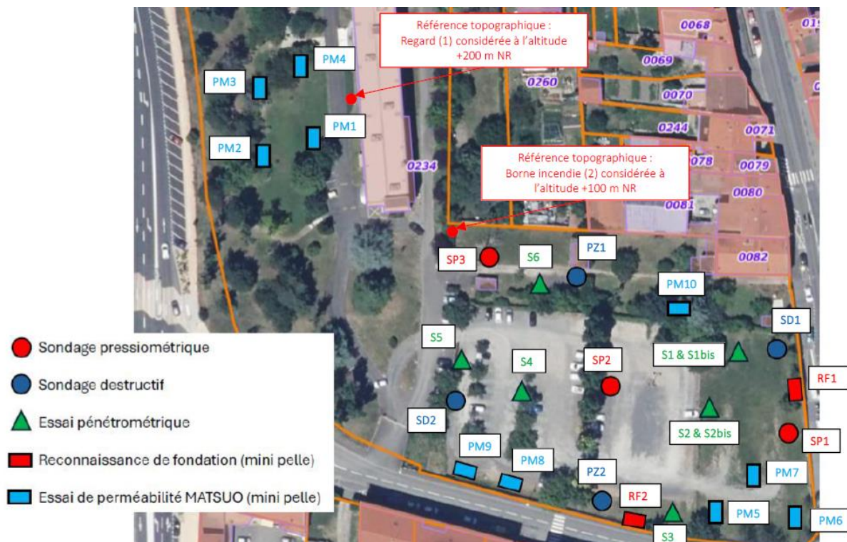
Figure 9 - Implantation des essais de perméabilité
