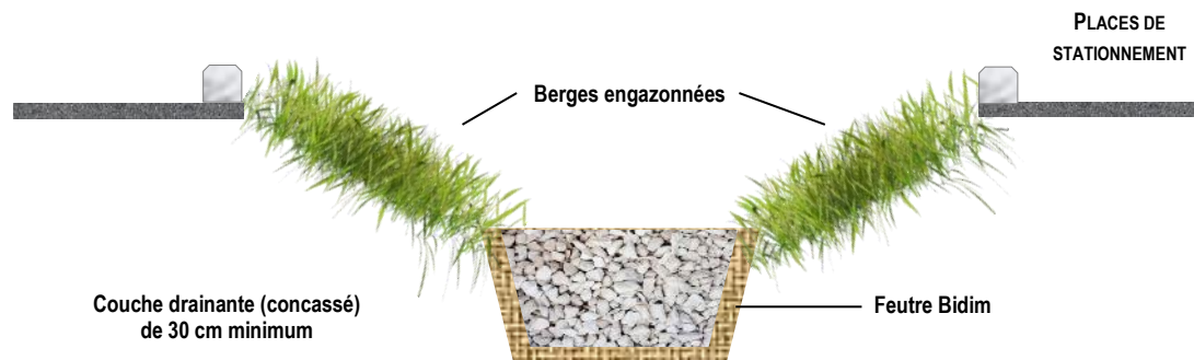
Figure 15 : Schéma de principe d'une noue avec couche drainante (© NATURALIA)
