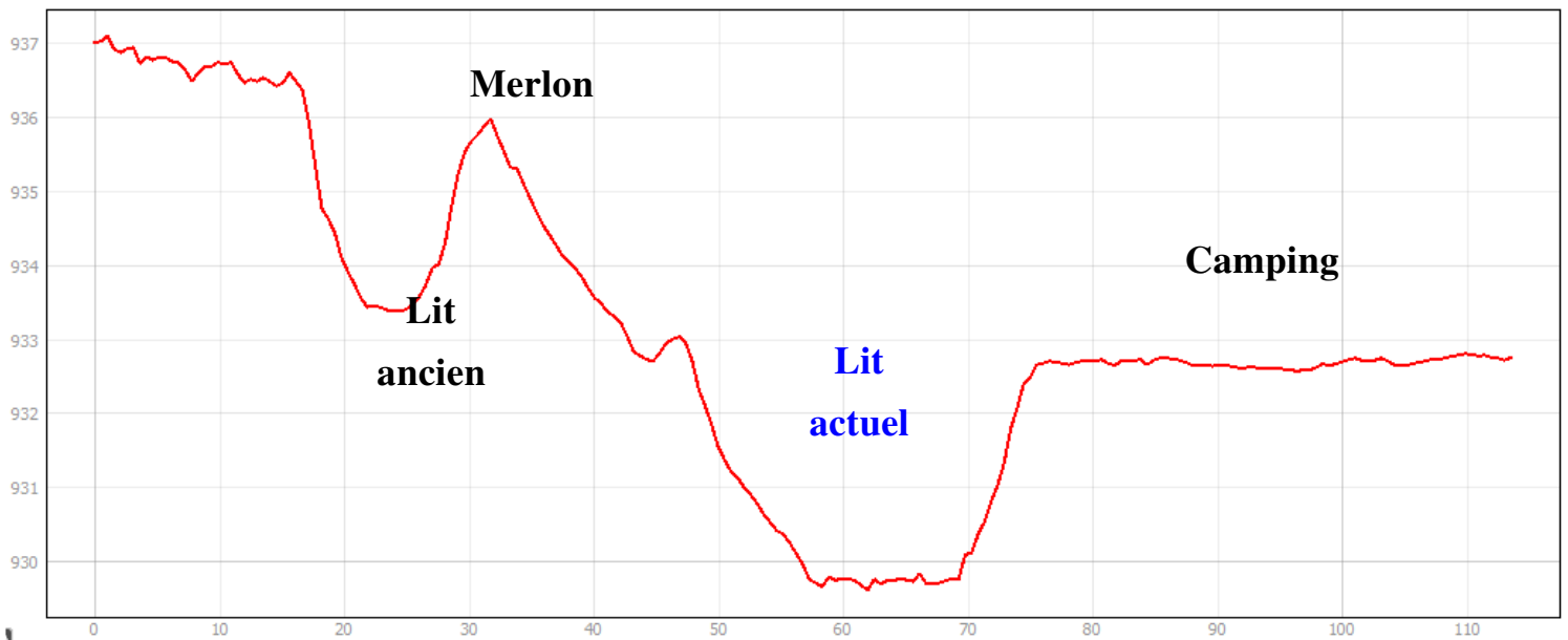
Figure 18 : Coupe type à l'amont du camping "le Champ du Moulin".
