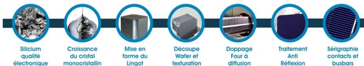
Figure 7 : Procédés de fabrication d'une cellule cristalline semi-conductrice de silicium (Jade Technologie, s.d.)
