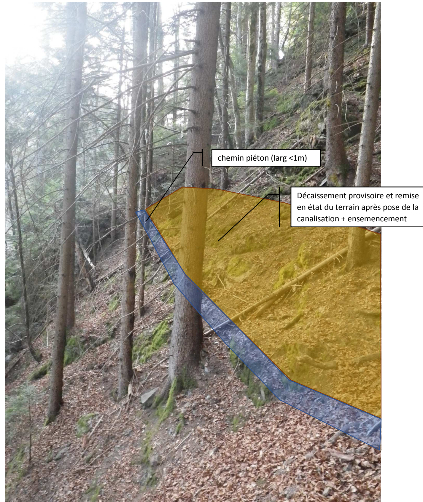
Illustration 3 : vue représentative du tracé de la conduite forcée
