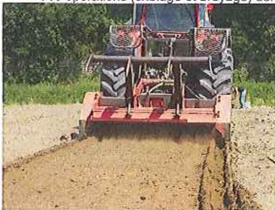
Photo 19 : Broyage au broyeur à pierre des matériaux étalés.
