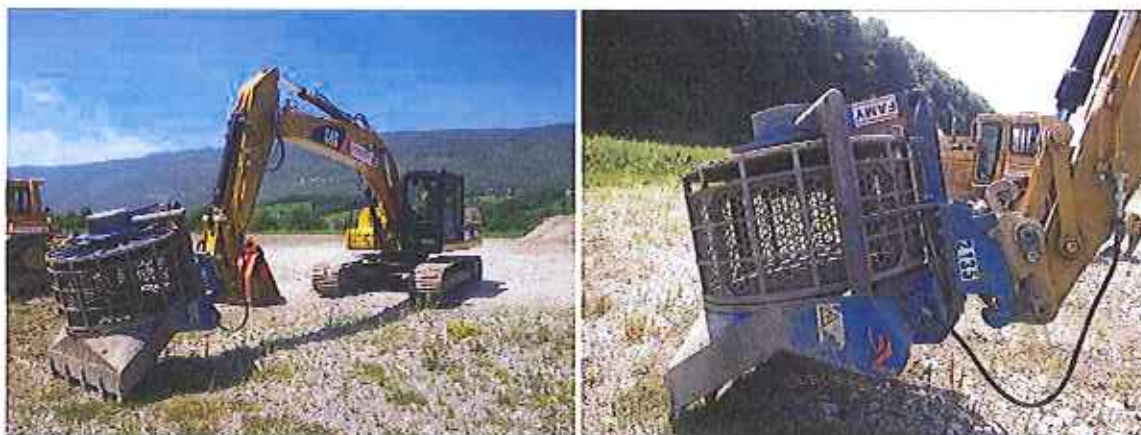
Photos 11 & 12 : Pelle mécanique équipée d'un godet criblo – détail du godet criblo.
