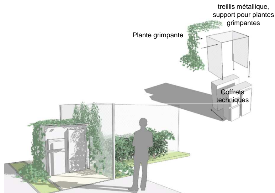
Illustration indicative de traitement des coffrets techniques intégrés à la clôture
