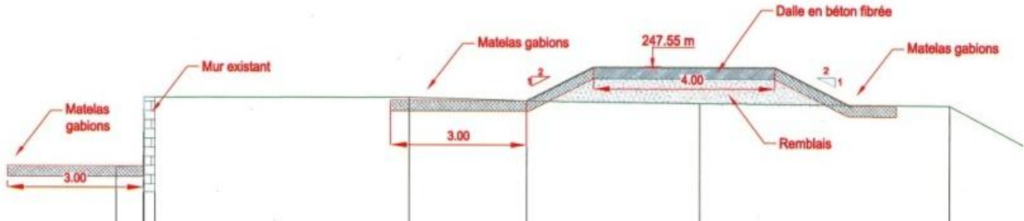
Figure 54 : Coupe de Principe du déversoir de sécurité
