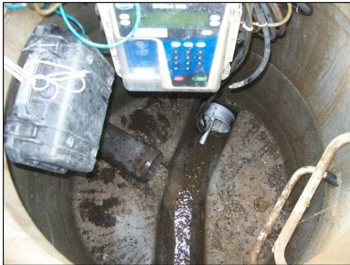
Débitmètre SIGMA 950 avec manchon déversoir
