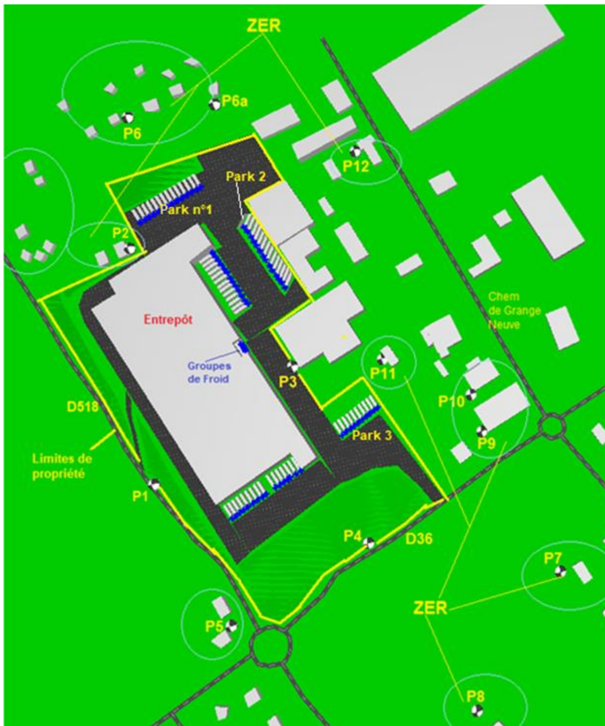
Figure 3 : Vue 3D indiquant la zone modélisée avec le logiciel CadnaA incluant les zones d'habitation les plus proches du projet, Les bâtiments de la zone industrielle situés à l'Est, les principales sources du bruit particulier ( Remorques et groupes de froid) ainsi que les points de mesures et des calculs.
