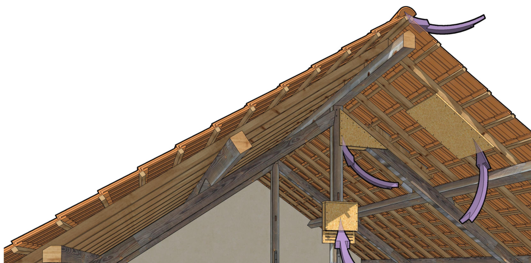
Aménagement de combles pour les chauves-souris
