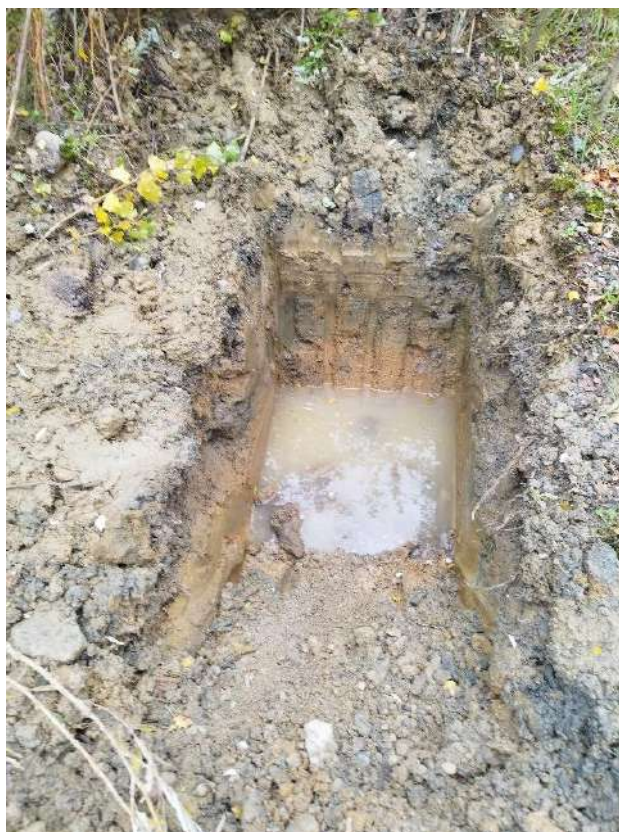
Figure 5 : Test d'infiltration sur le sondage PM1
