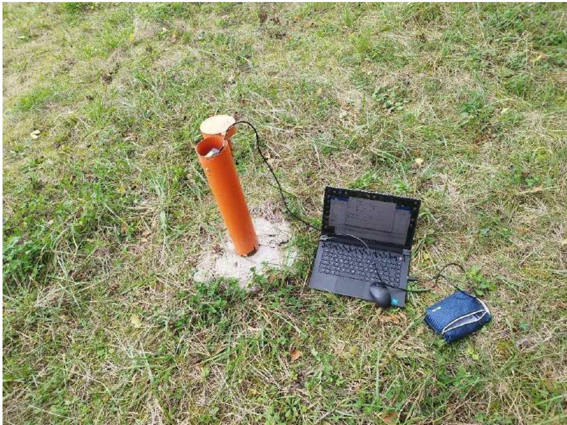
Figure 7 : Equipement du piézomètre n°6 avec une sonde de suivi automatique OTT Orpheus mini
