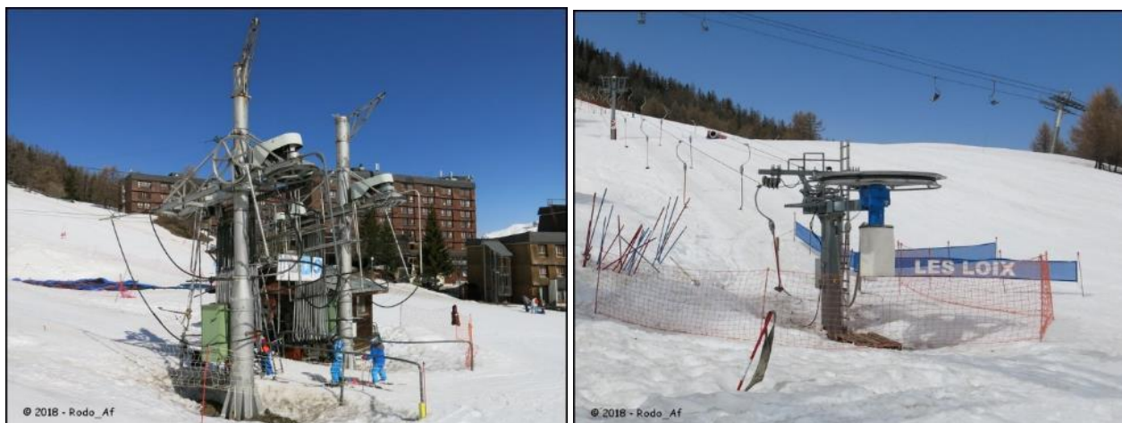
COMPARAISON ENTRE LES GARES DES TELESKIS DES PRES ACTUELS (A GAUCHE) ET D'UN TELESKI A ENROULEURS MODERNE (TELESKI DES LOIX, A DROITE) – SOURCE REMONTEES-MECANIKES.NET
