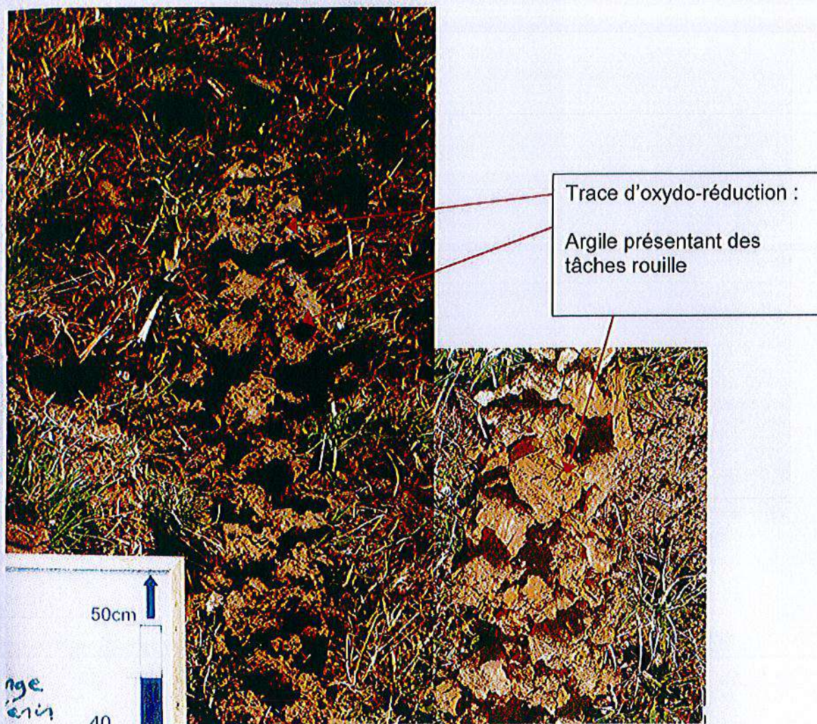
Figure n° 9: Traces d'hydromorphie sur les carottes des sondages S6 et S9
