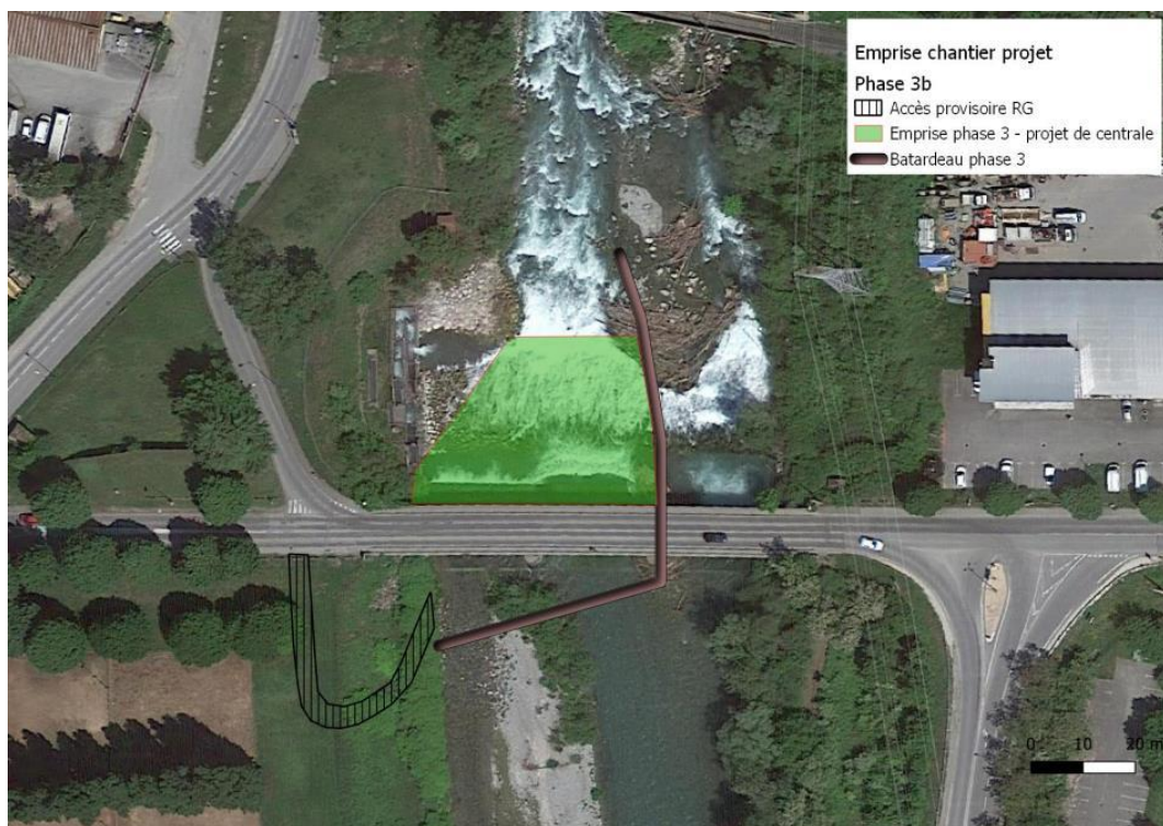
Figure 12 : Etape 3 – Période début juillet à mi-octobre Travaux de déplacement du seuil, de construction du mur de seuil et des enrochements et pose des clapets mobiles sur la partie rive gauche et centrale du seuil. La montaison sera maintenue lors de cette phase.
