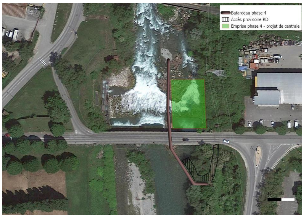
Figure 13 : Etape 4 – Période fin avril à début juillet. Travaux de déplacement du seuil, de construction du mur de seuil et des enrochements, pose des clapets mobiles sur la partie rive droite du seuil, mise en place de la rampe à faune terrestre en rive droite. La montaison sera maintenue lors de cette phase.
