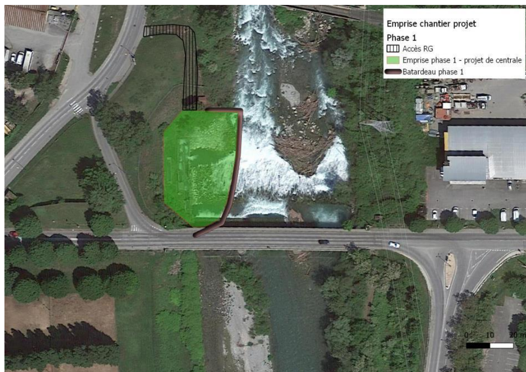
Figure 10 : Etape 1 – Période fin octobre à début février. Pose d'un batardeau pour la mise hors d'eau de la rive gauche. Travaux de démolition de la passe à poissons et d'excavation des zones du canal d'amenée, de la centrale et de la nouvelle passe à poissons.
