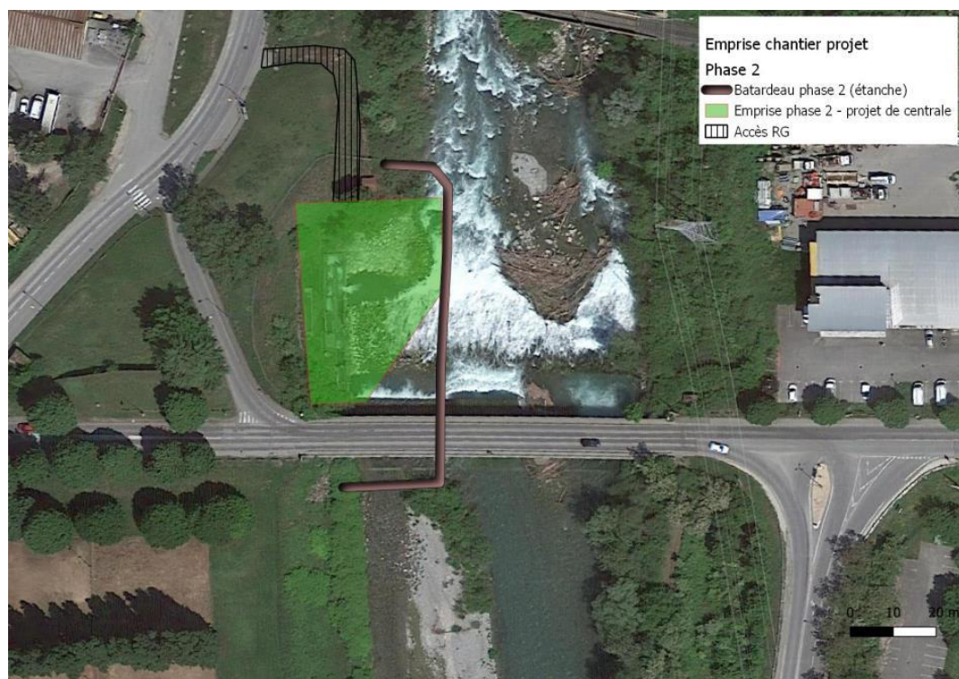
Figure 11 : Etape 2 – Période début février à fin octobre. Pose d'un batardeau pour la mise hors d'eau de la rive gauche. Travaux d'ouverture et de déplacement du seuil, construction de la prise d'eau, du chemin d'amenée, du bâtiment de centrale et de la nouvelle passe à poissons.
