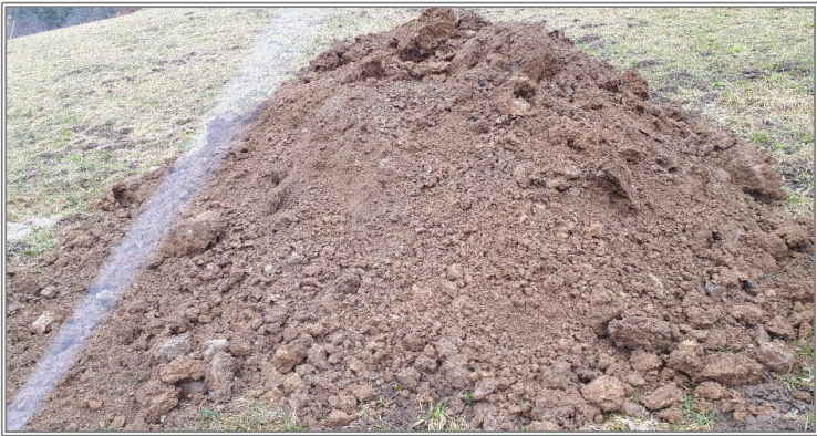
Sondage S9 et matériaux extraits
