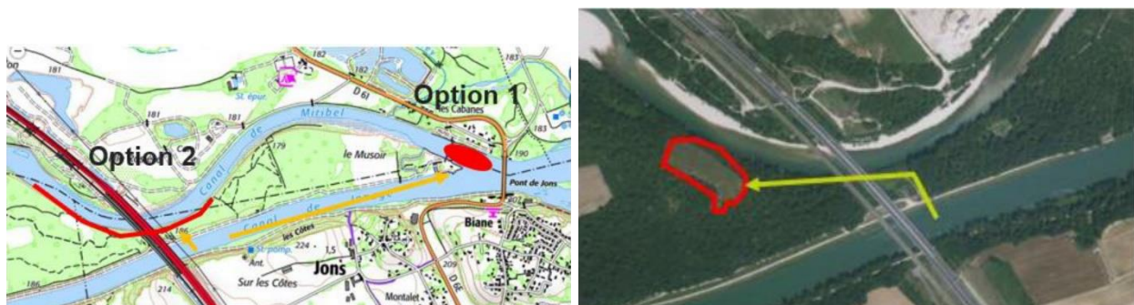
Figure 14 : Réinjection en amont et en aval de Jons avec dépôt à terre (Source : EDF)
