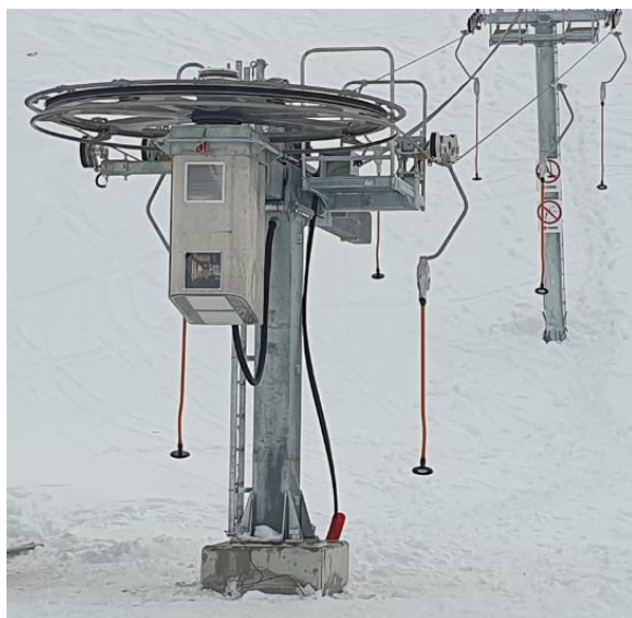
Photo 10 Exemple de gare motrice tension
