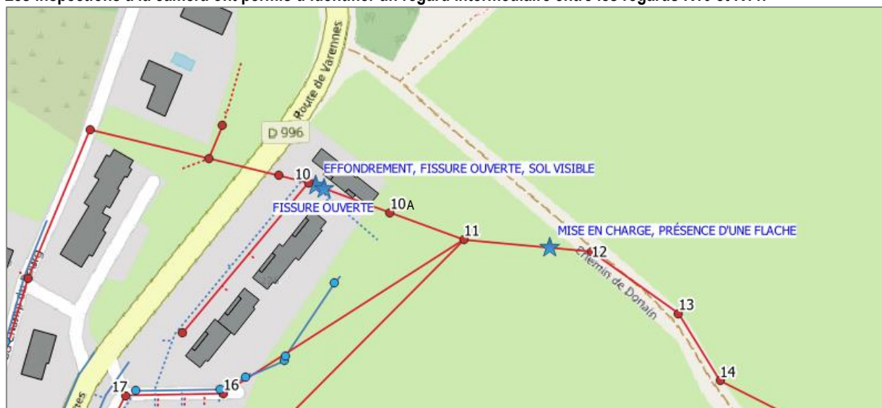
Figure 6 : Résultats des inspections des passages caméra
