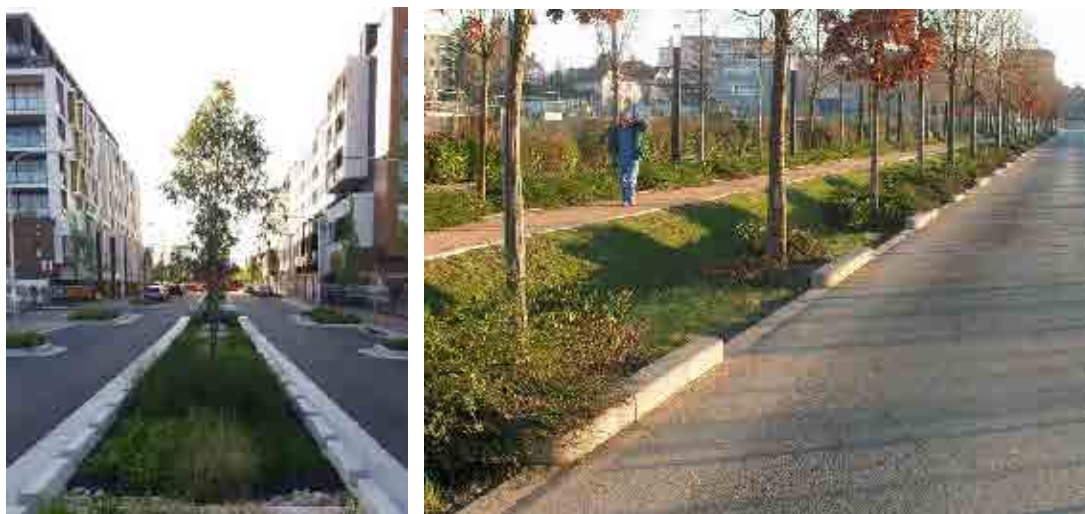
Photo 5 : Illustrations du principe de noue avec bordures arasées pour évacuation des eaux pluviales
